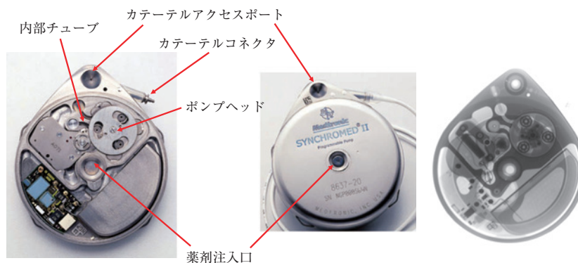
Fig. 1 バクロフェンポンプの構造. 内部の駆動部の動きはレントゲンで観察できる (右)
